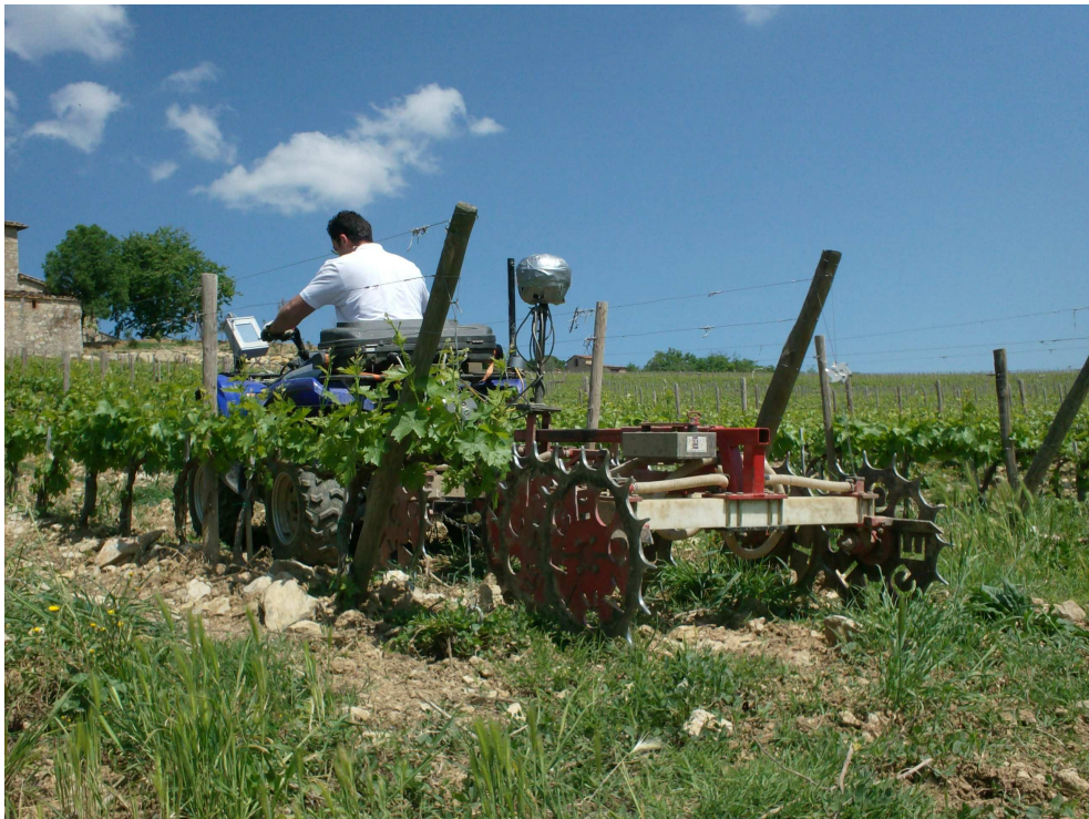
Figura.1 –ARP dotato di elettrodi trainato da Quad dotato di GPS differenziale e computer di bordo.
